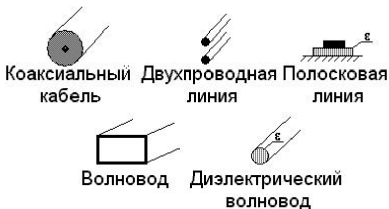
Рис. 1.2. Типичные линии передачи
