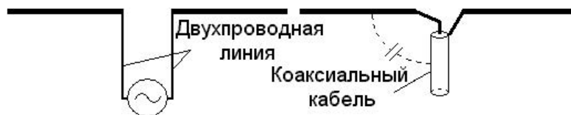
Рис. 3.21. Симметрированный (слева) и несимметрированный (справа) вибраторы
